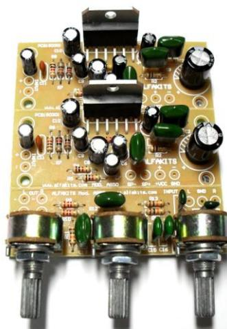
Primeiramente queremos agradecer a aquisição do KIT PLACA AMPLIFICADOR 50W RMS ESTÉREO Mod.AS-50 da ALFAKITS. Este manual procura detalhar todo o processo de montagem desse amplificador, permitindo que mesmo quem não tenha qualquer experiência com eletrônica possa executá-lo com sucesso e em segurança.
