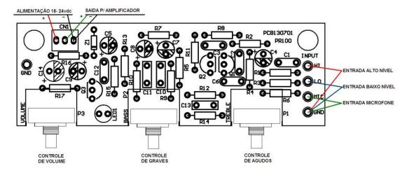
Caso o PR100 seja adquirido juntamente com nossos módulos e KIT´s amplificadores, basta conectar o cabo de três vias (\*) à placa do amplificador de potência para que se aproveite a própria fonte de alimentação do módulo, e também a saída do pré já será conectada a entrada do módulo amplificador.
